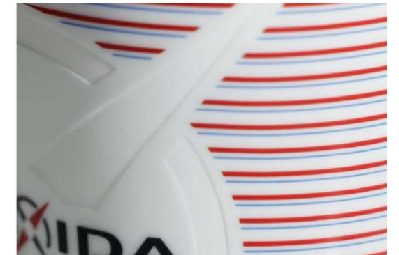
gravierter Druck (Verbindung von Gravur und Siebtransferdruck)
